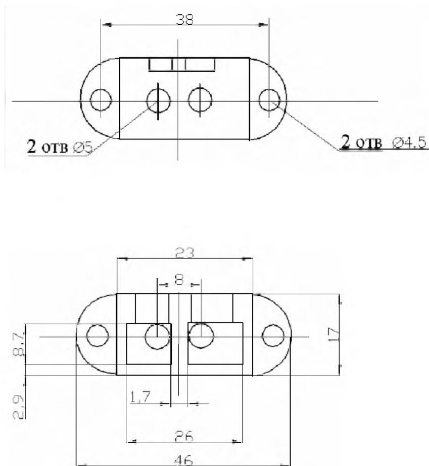
**Назначение:** для организации соединения электродов термопреобразователей с присоединительными проводами.
