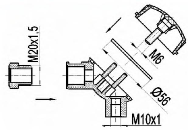
**Назначение:** монтажный комплект применяется для подсоединения кабеля от вторичного прибора к термопреобразователю.
